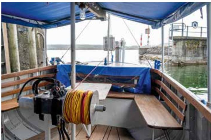
Zum Tonnenlegen wurde „Gisela“ mit einer hydraulischen Winde ausgestattet. BILD: BENGELSDORF
